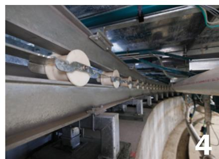
**5** O trabalho continua no chassi da sala de ordenha, que inclui os raios da plataforma. A resistência da plataforma depende de boas peças, boa soldagem e bom ferramental por parte dos construtores. Tudo deve estar no lugar certo e no ângulo certo. Cada suporte e cada furo tem um local específico.
