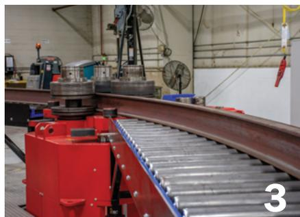
**4** Os roletes de náilon para serviço pesado (mostrados já instalados) são o que ajudam o giro rotativo nas vigas. Esses roletes têm um perfil especial na estrutura para um desgaste mínimo com alinhamento seguro.
