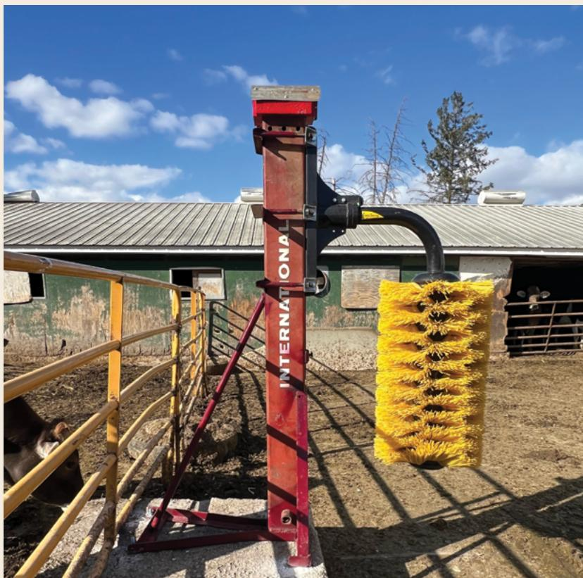
Recentemente, compramos uma escova para gado e precisávamos de uma boa maneira de colocá-la, por isso construí um suporte com materiais reciclados. Usei uma lingueta de plantadeira para a coluna, uma cantoneira de um elevador de fardos para a base, uma dobradiça de porta grande para fazer um batente ajustável a fim de garantir que a escova não deslize pela coluna e uma haste rosqueada.
